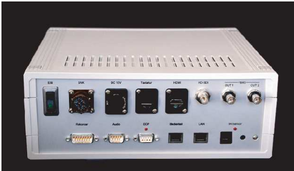
Breakoutbox mit allen Schnittstellen
